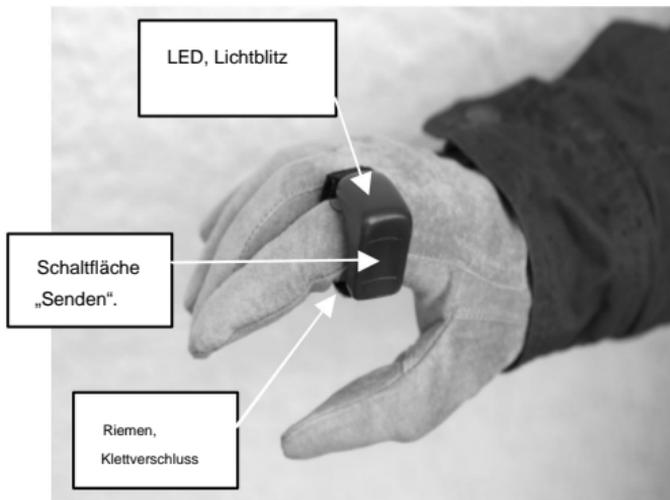
Der „**Finger Kick**“ nutzt die Fernbedienung als Relais für große Entfernungen. Daher ist es wichtig, dass sich der „**Finger Kick**“ in der Reichweite der Fernbedienung befindet, also weniger als 5 Meter.
